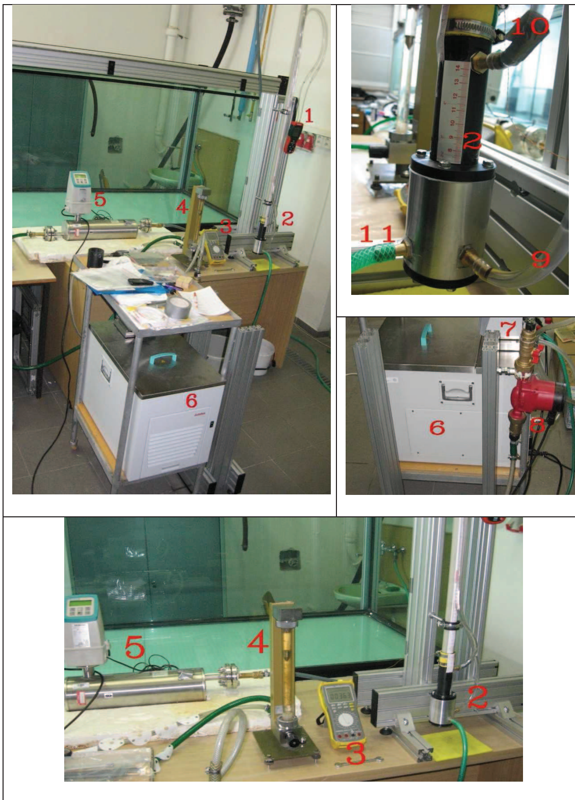
Obrázek č. 33: Strojní měřicí zařízení, určené k zjištění experimentální propustnosti vody.
